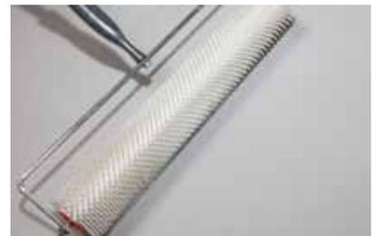
14. Unmittelbar danach wird die Beschichtung zur Entlüftung mit einer Stachelwalze durchgezogen. Bei der Verarbeitung empfiehlt sich das Tragen von Nagelschuhen.
